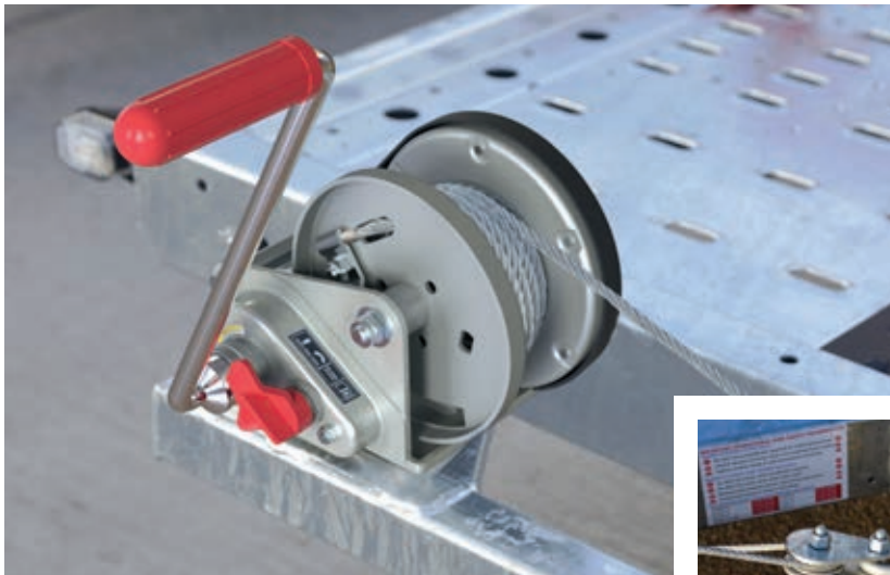
○ Manuelle Winde, aut. Bremse + 6-fach Schnellverstellung.
